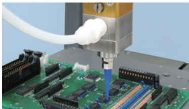
基板上的IC端子に防湿剤を塗布
