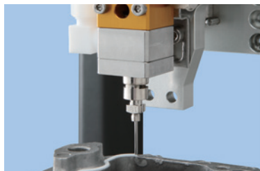
変速機ケーシングにシール剤を塗布
