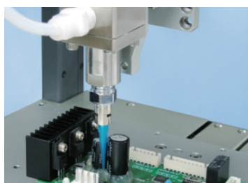
基板上的のコンデンサ周囲にシリコンを塗布
